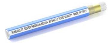
Manguera de PVC plastificado doblemente reforzada con fibra de poliéster y capa intermedia adhesiva de PU para impulsión a presión de líquidos alimentarios en aplicaciones de limpieza industrial.
